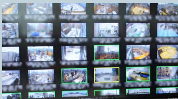
▲作業員が安全帯を装着していないとフレームが黄色に変わる
